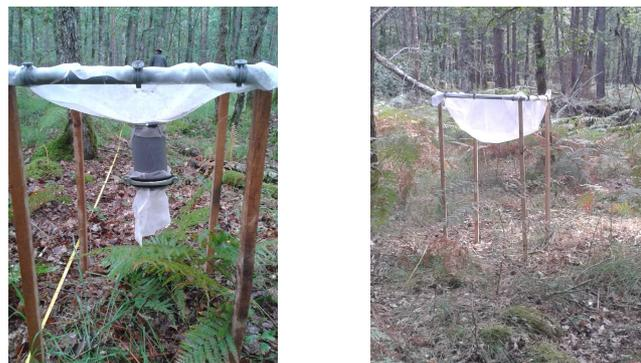
Figure 2: Photographies de deux types de collecteur de litière: à gauche, collecteur d'une surface de collecte de 0,25 m<sup>2</sup>, avec un sac récupérateur; à droite, collecteur plus grand et plus profond avec une surface de collecte de 0,5 m<sup>2</sup>.
