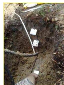
**Figure 7 : Présentation des zones d'insertion des sondes d'humidité dans une fosse type, et photos du câblage (photos V. Seigner).**
